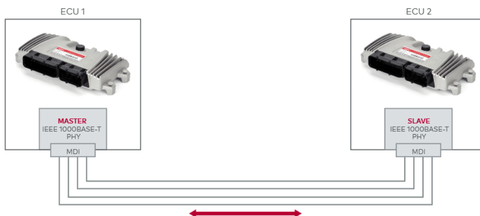
Obr. 1.17 Spojenie fyzickou vrstvou typu IEEE 1000 BASE – T, ZDROJ: Prevzaté z (Vector Informatik GmbH, 2018)
