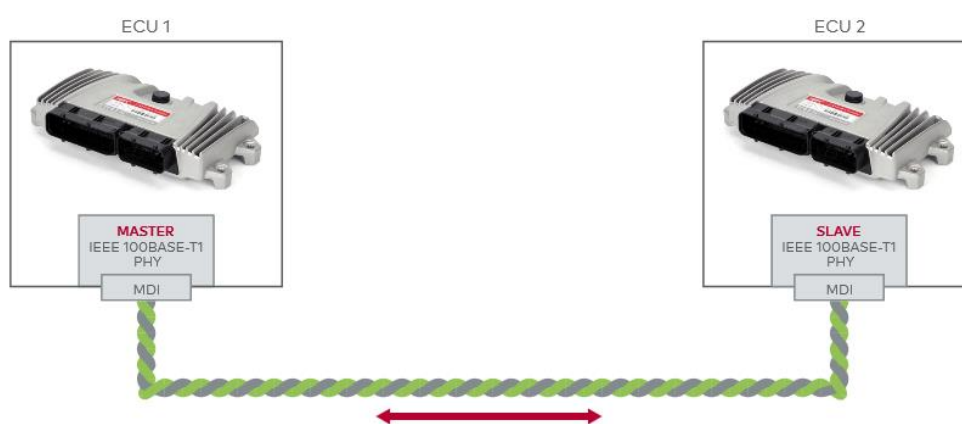
Obr. 1.15 Spojenie fyzickou vrstvou typu IEEE 100 BASE – T1, ZDROJ: Prevzaté z (Vector Informatik GmbH, 2018)
