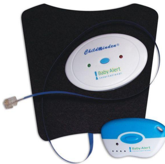
Obr.1-8 Zariadenie ChildMinden na detekciu tlaku v autosedačke Zdroj: Prevzaté z (COXWORTH, 2012)
