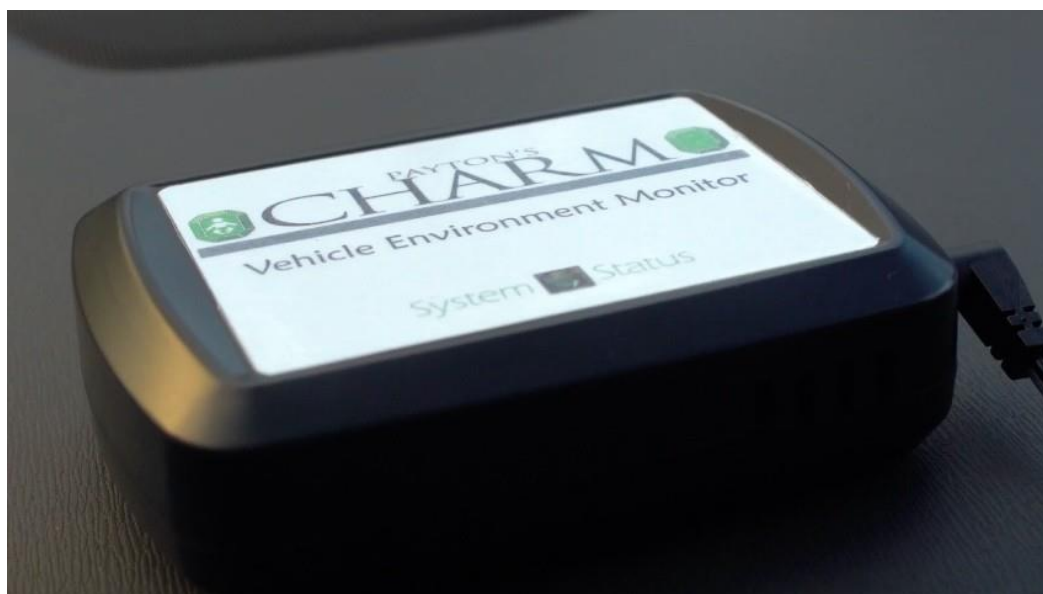
Obr. 1-9 Zariadenie Payton's Charm na detekciu snímania teploty a oxidu uhličitého vo vnútri auta Zdroj: Prevzaté z (COXWORTH, 2018)
