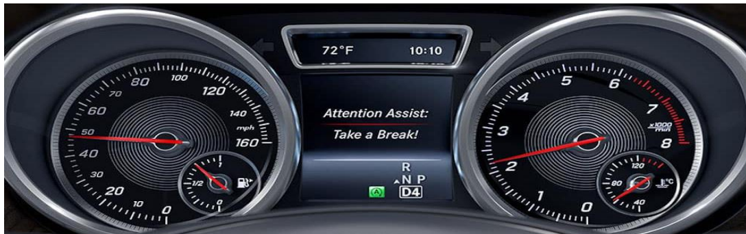
Obr. 1-6 Systém v automobile Mercedes Benz zabezpečujúci ochranu vodiča pred mikrosnávkou Zdroj: Prevzaté z (MERCEDES BENZ, 2018)
