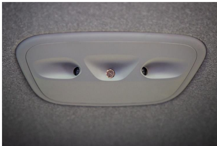
Obrázok 23: Tri ultrazvukové snímače (Karpát, 2018)
