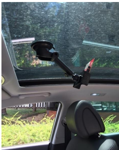
Obrázok 27: Inštalácia snímača vln na strešné okno vozidla (Texas Instruments Incorporated, 2018)
