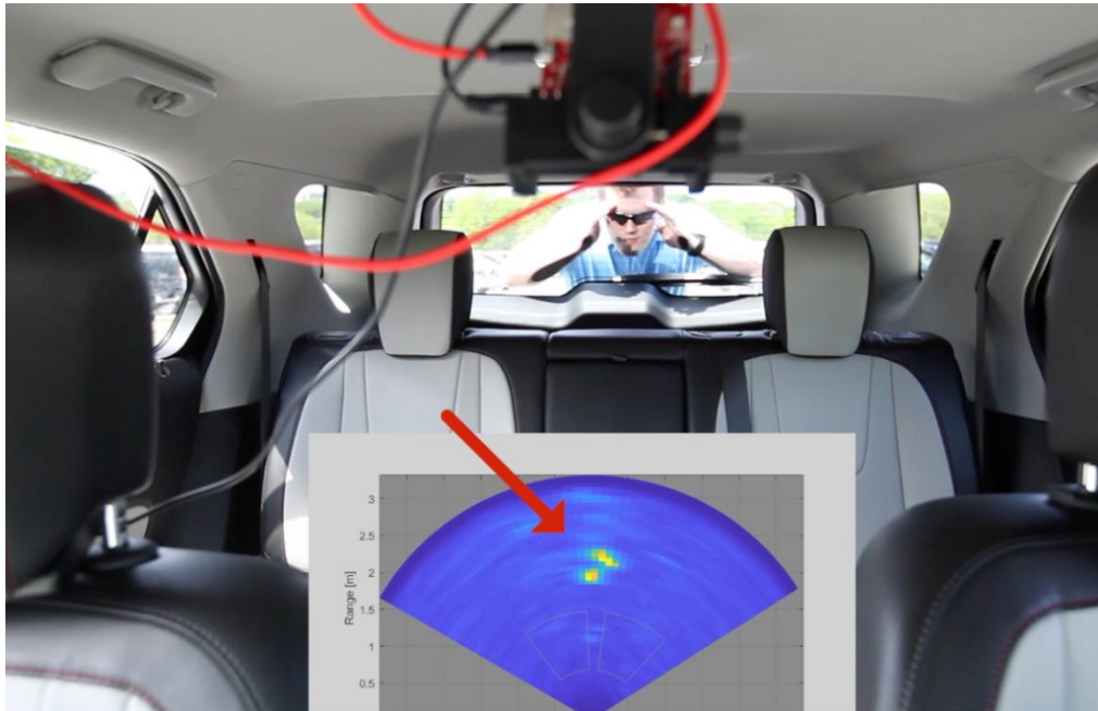
Obrázok 30: Snímač mmWave deteguje možného narušiteľa za vozidlom (Texas Instruments Incorporated, 2018)
