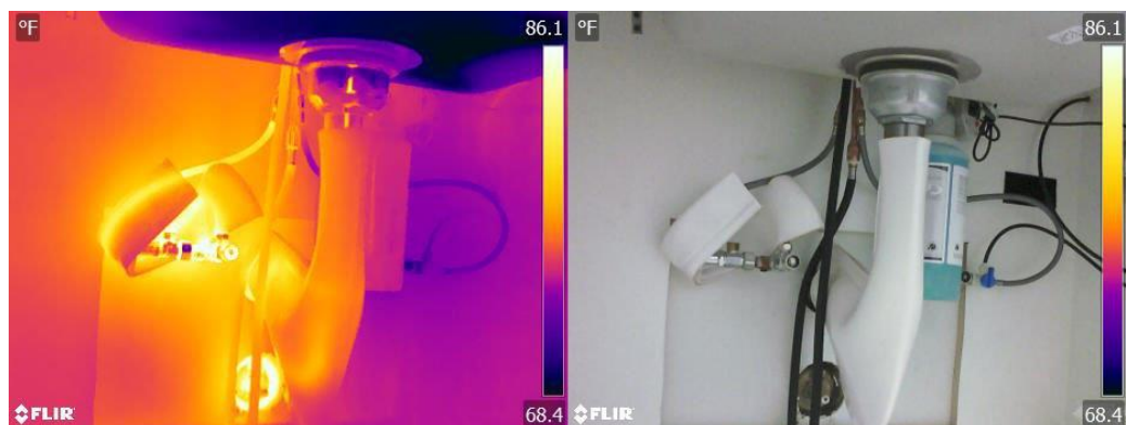
Obrázok 12: Tepelný a viditeľný obraz nasnímaný súčasne (2019 © FLIR ® Systems, Inc. , 2019)
